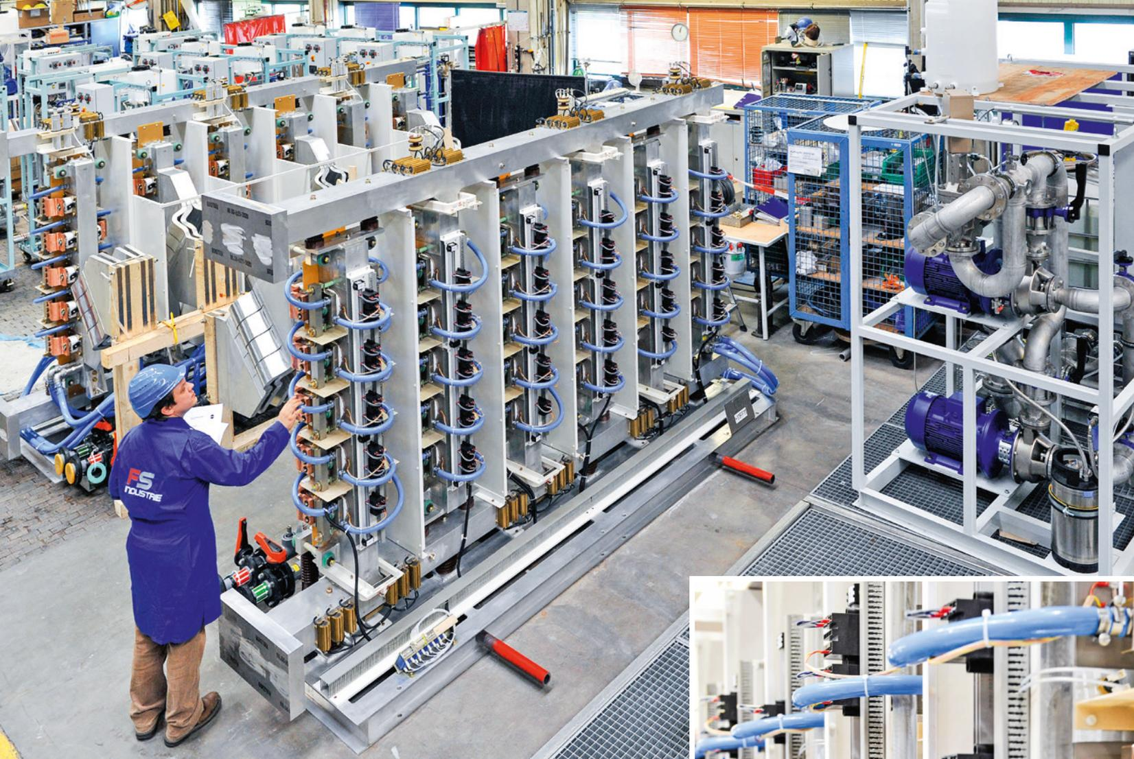
Für unsere Auftraggeber fertigen wir komplette Industrieanlagen mit hohem technischem Anspruch – z. B. Hochstromgleichrichter für den Bereich Energieerzeugung und -verteilung, die strengste Qualitäts- und Prüfanforderungen erfüllen. Mit jahrzehntelangem Know-how auf diesem Gebiet kombinieren wir technisch anspruchsvolle Hochspannungskomponenten in verschiedenen Fertigungsschritten:
